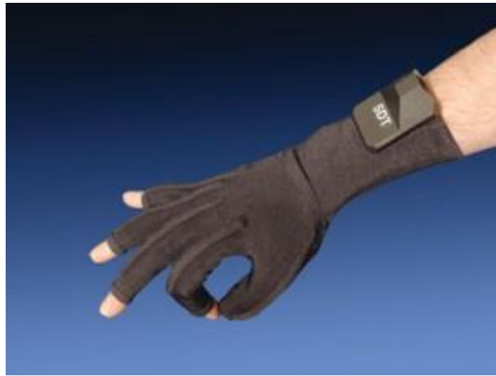
Figura 1. Guante de realidad virtual sensorizado.
