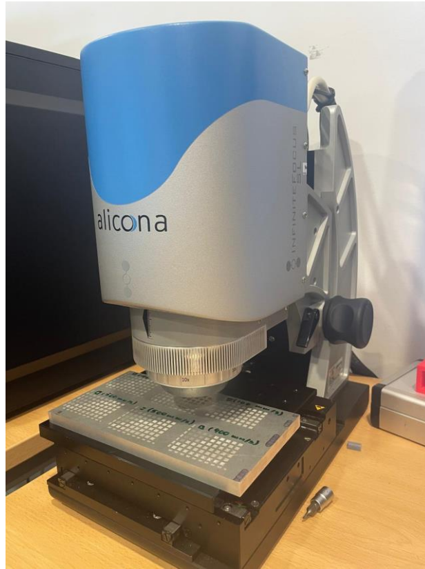
Figura 49: Placa de Aluminio 7075 tratada y lista para ser medida en Alicona InfiniteFocusSL
