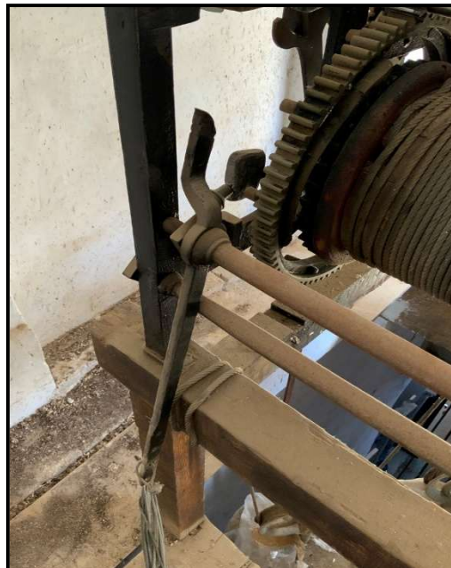
Figura 48: Actuador de sonido de las campanas de las horas desconectado. Fuente: propia
