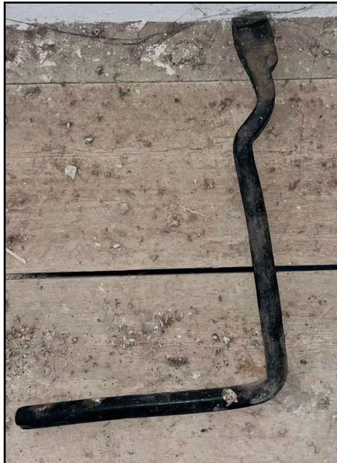
Figura 24: Manivela para el remontaje desmontada. Fuente: propia
