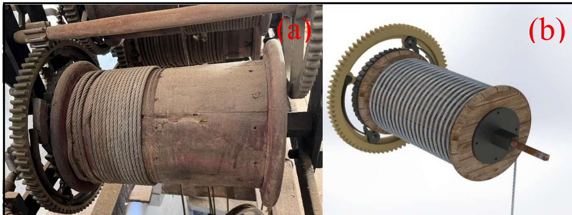
Figura 125: Rueda imperial del sistema sonería de las horas real y su recreación. Fuente: propia
