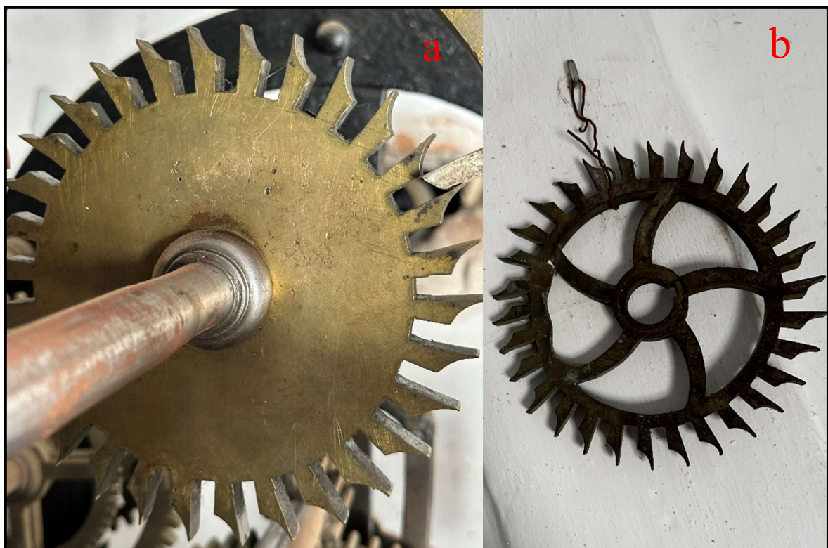
Figura 54: Rueda de escape nueva y la original de izquierda a derecha. Fuente: propia
