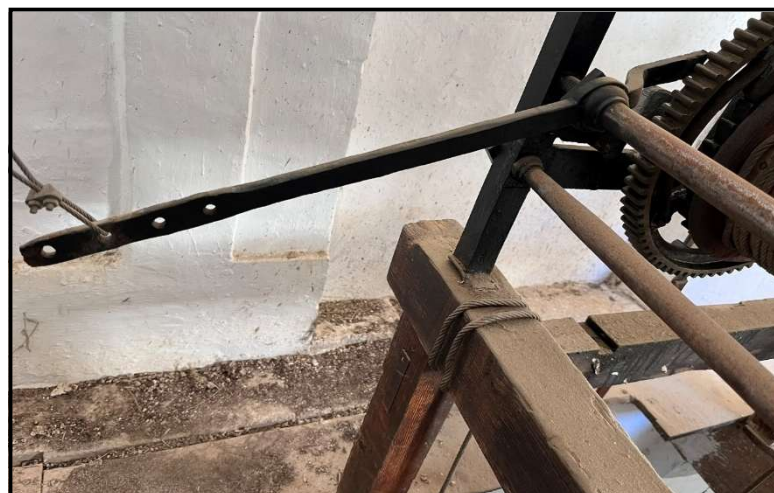
Figura 49: Actuador de sonido de las horas en su correcta posición. Fuente: propia
