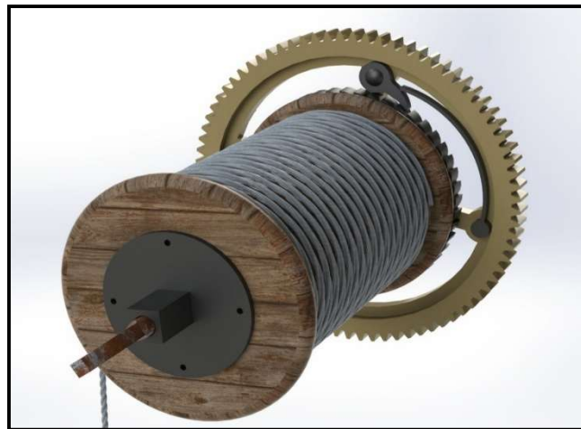
Figura 111: Recreación de la rueda imperial junto a el eje que la sostiene a la estructura. Fuente: propia
