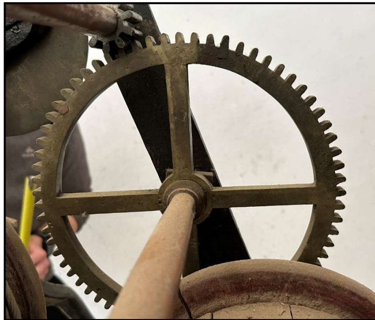
Figura 115: Rueda segunda del mecanismo de sonería de cuartos real. Fuente: propia
