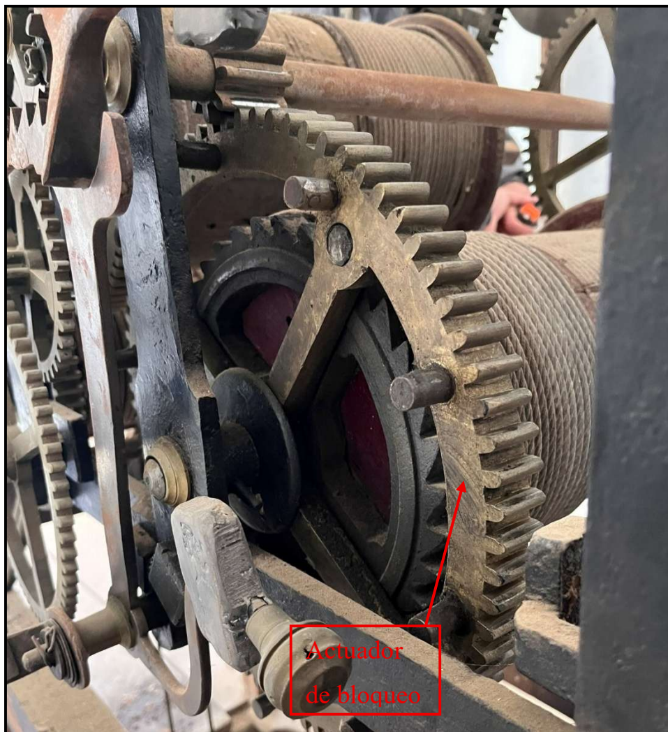
Figura 42: Rueda de engrane del mecanismo de sonería de las horas. Fuente: propia
