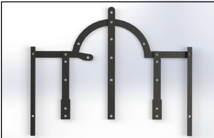
Figura 151: Recreación de la parte frontal de la bancada. Fuente: propia
