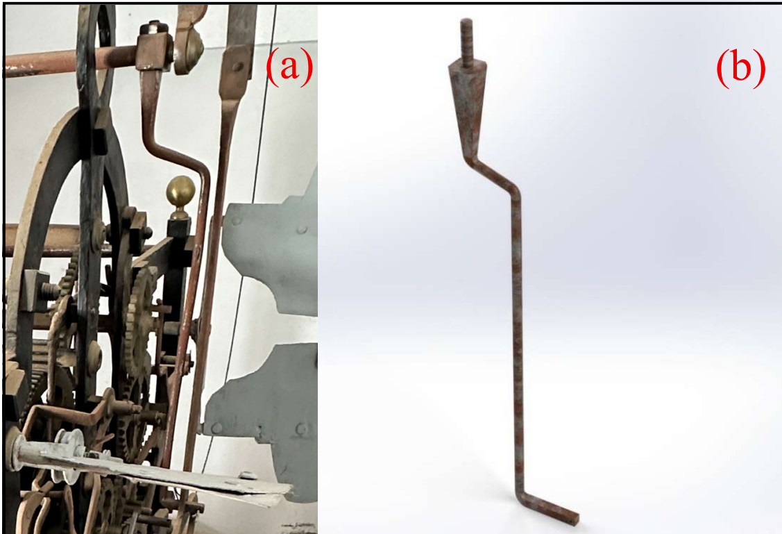
Figura 144: Tenedor del péndulo real y recreación. Fuente: propia
