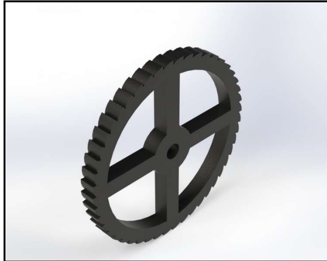
Figura 105: Recreación del trinquete del mecanismo de sonería de cuartos. Fuente: propia
