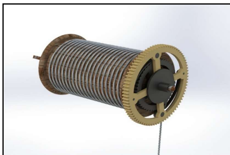
Figura 134: Rueda imperial del sistema de movimiento real. Fuente: propia
