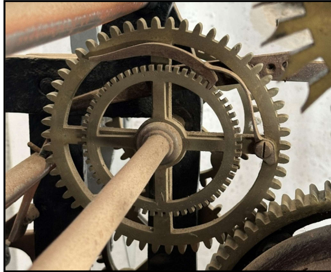
Figura 57: Rueda minuterá junto con sistema de embrague y rueda que engrana con sistema de movimiento. Fuente: propia
