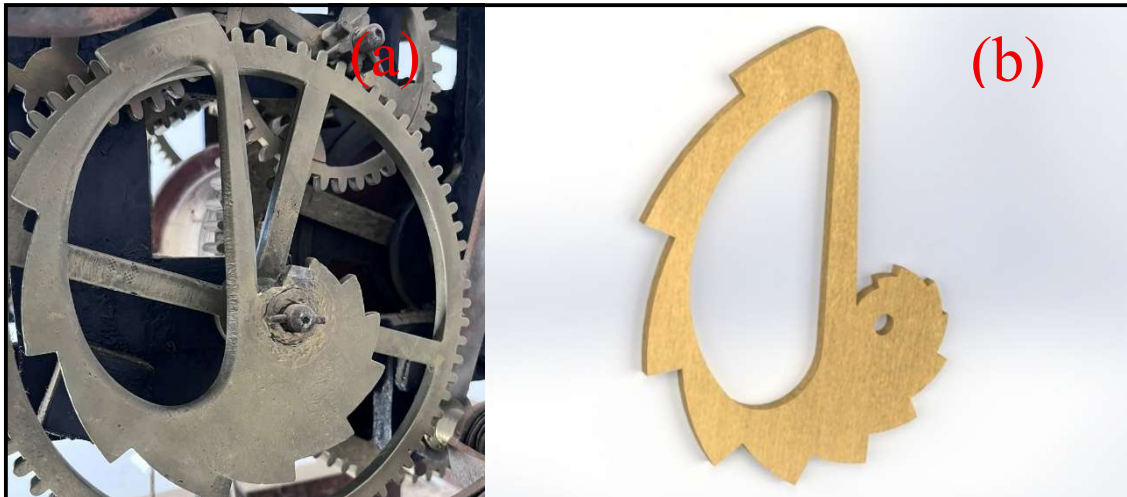
Figura 127: Caracol del sistema de sonería de las horas real y su recreación. Fuente: propia
