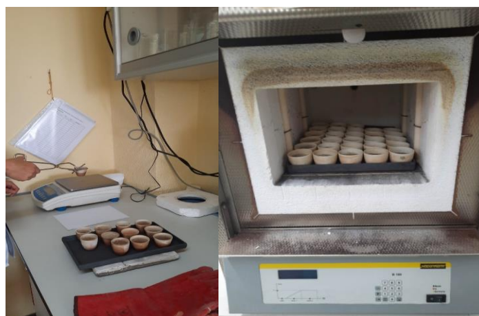
Figura 3.4. Proceso de pesado y calcinación de las muestras de sedimento en la mufla.
