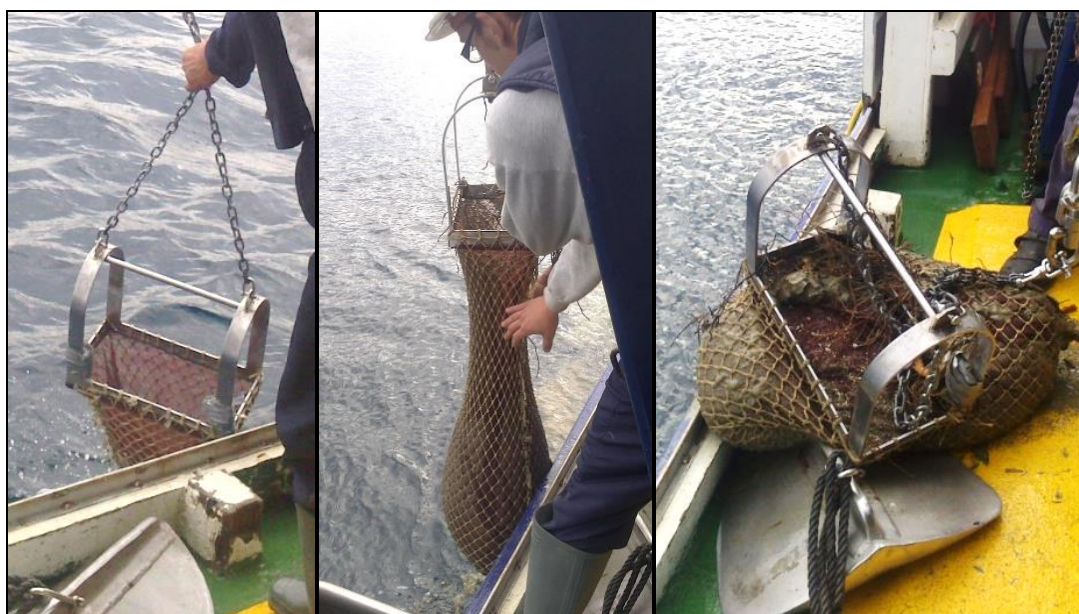
Figura 3.5. Draga de arrastre empleada para la recolección de las muestras de fauna bentónica.
