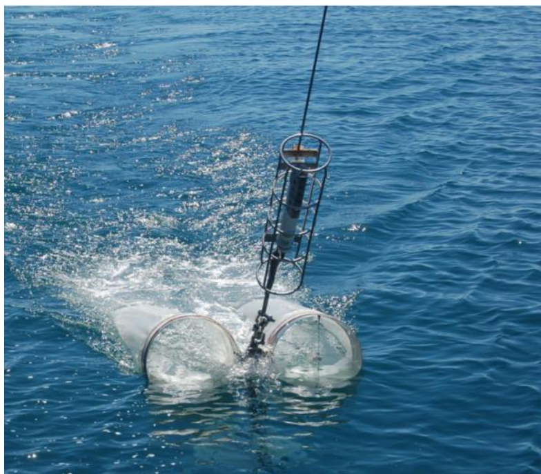
Figura 3.1. CTD SBE 37 acoplado a la red de tipo Bongo durante una campaña del proyecto REMALA.
