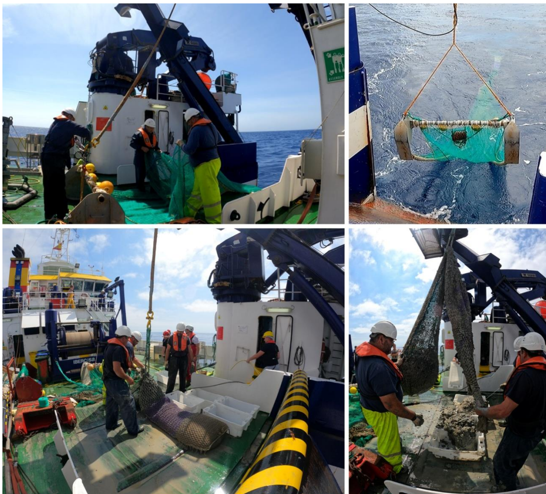
Figura 3.7. Detalles del Beam-trawl en cubierta y durante su largado por la rampa de popa (arriba). Muestra recolectada por el Beam-trawl sobre cubierta (abajo izquierda) y reparto de la muestra en diferentes cajas para su posterior procesado (abajo derecha).
