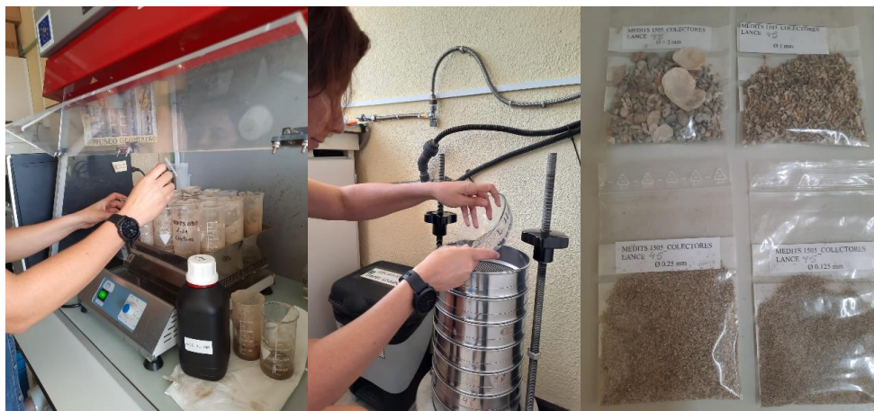
Figura 3.3. Proceso de oxidación de muestras de sedimento en la campana extractora, así como el posterior tamizado y etiquetado de dichas muestras.
