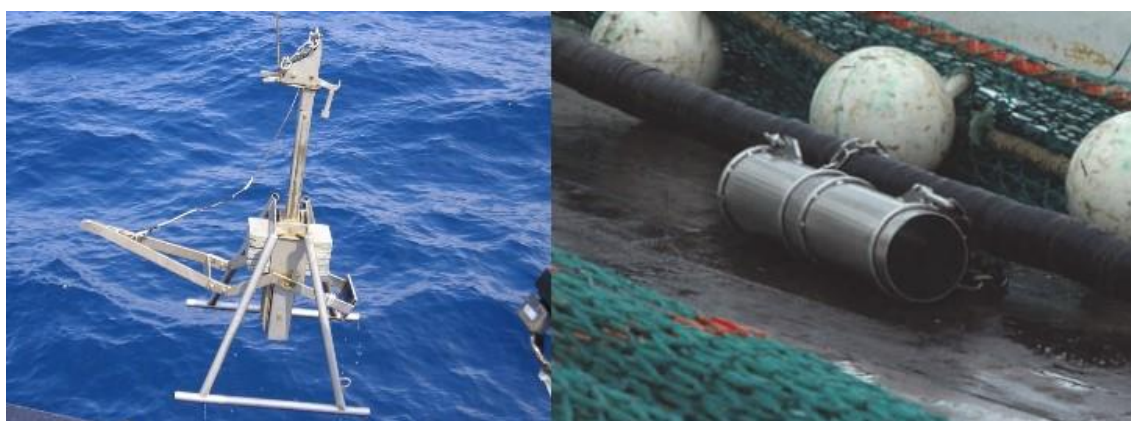
Figura 3.2. Draga box-corer (izquierda) y colector de sedimento (derecha) utilizados para la recogida de sedimentos durante las campañas oceanográficas de muestreo.
