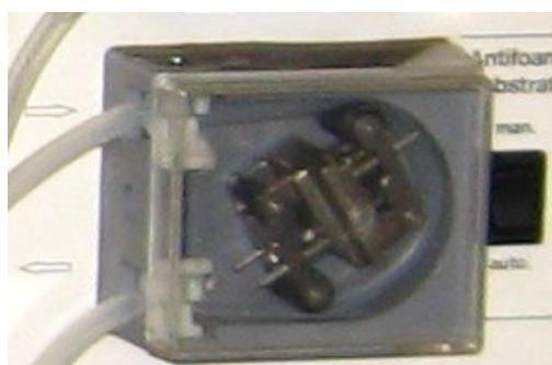
Figura 76 Detalle de dispositivo peristáltico
