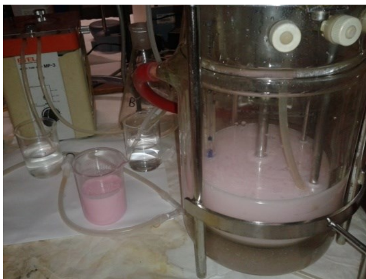
Figura 91 Ensayo con emulsión alimentaria: Reactor y emulsión original
