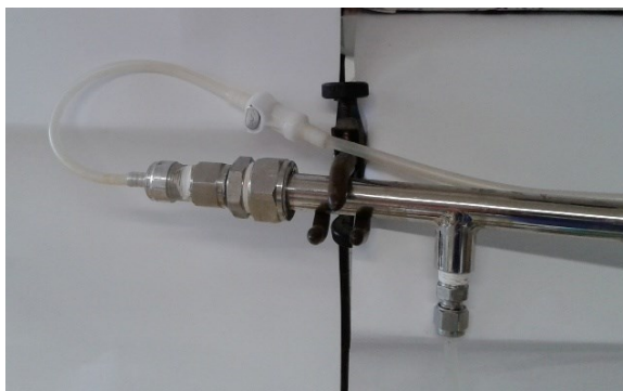
Figura 46 Reactor tubular. Entrada de impulsión y salida de filtrado
