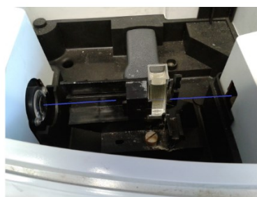
Figura 20 Compartimento de muestras del espectrofotómetro
