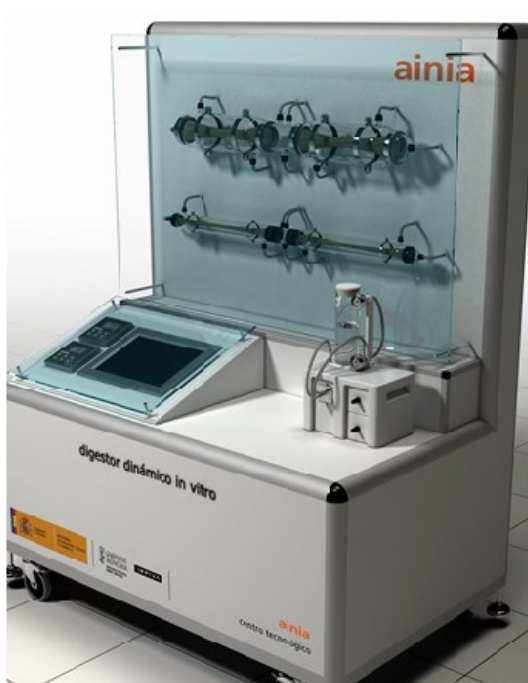
Figura 8 Digestor dinámico in vitro desarrollado por Ainia
