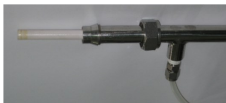
Figura 13 Detalle de membrana de filtración y salida de producto filtrado
