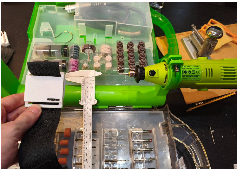
Figura 11: Proceso de ajuste manual del encapsulado mediante herramienta rotativa
