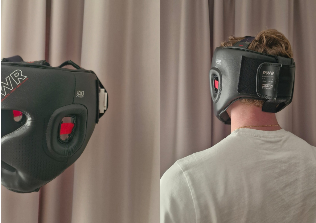
Figura 12: Dispositivo integrado en el casco, mostrando la fijación mediante sistema de velcro estructural.
