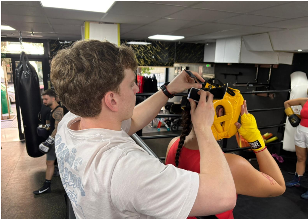
Figura 13: Proceso de instalación del dispositivo en casco de entrenamiento previo a una sesión de sparring , durante la fase de validación experimental.
