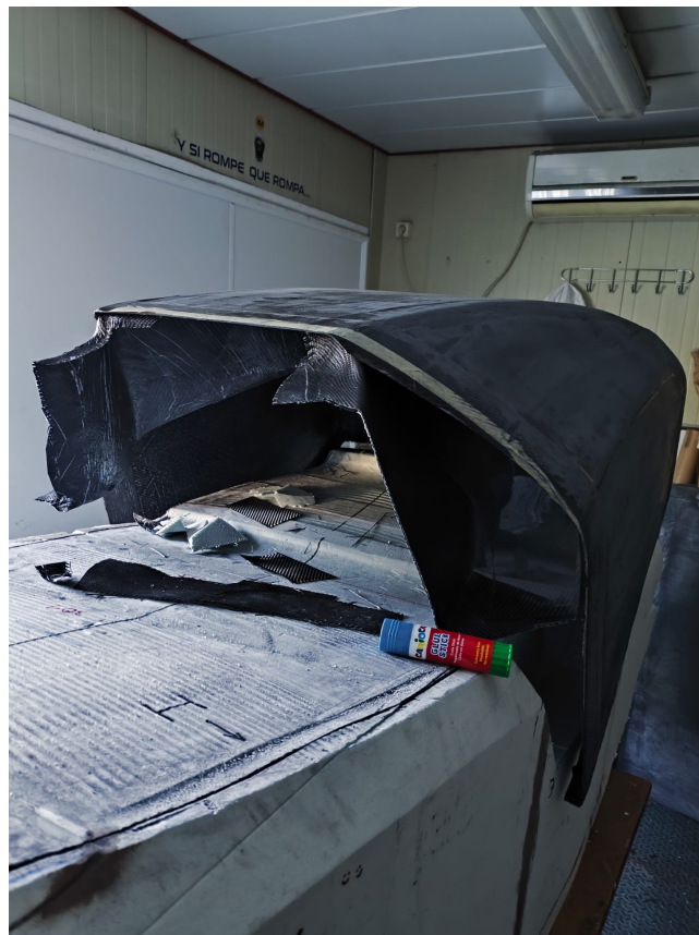
Figura 87: Fabricación de la parte trasera del monoplaza Fuente: Departamento de Aerodinámica [7]
