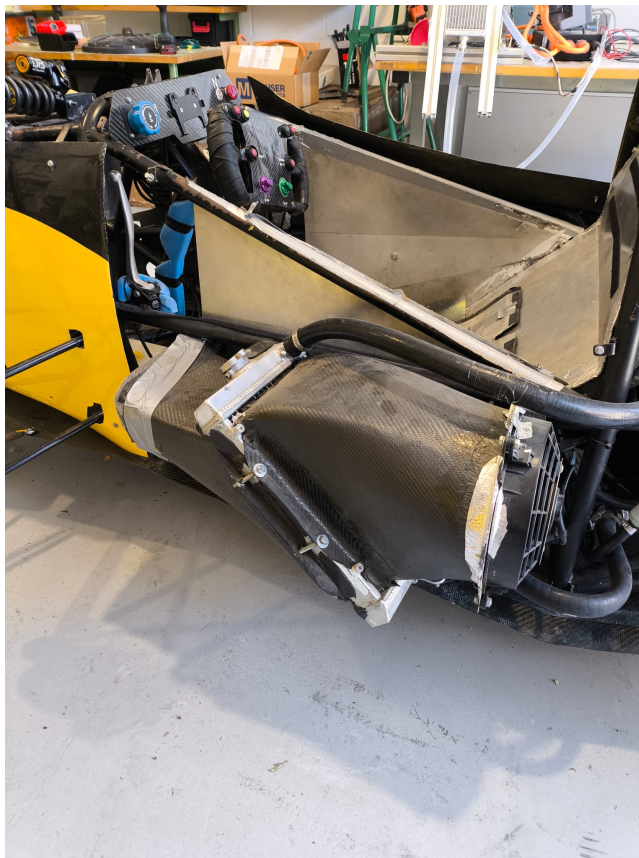
Figura 19: Pontones monoplace de combustión MART FS Fuente: Mart FS [7]
