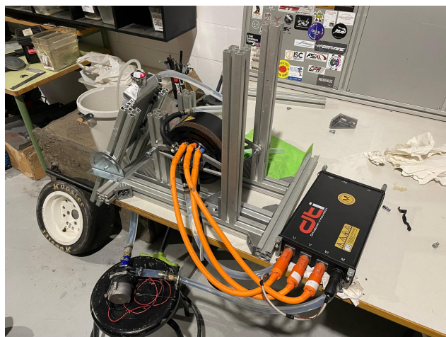
Figura 57: Prueba de bombeado de refrigerante a través del circuito
