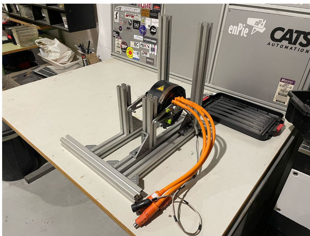
Figura 55: Proceso de fabricación del banco de ensayo
