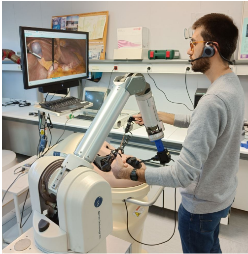
Figura 10: Fotografía de un operario utilizando el simulador y dando órdenes de movimiento a la cámara mediante comandos de voz.
