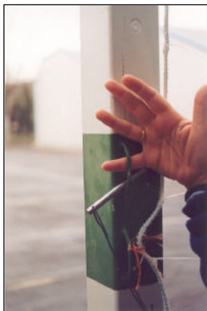
Portería. Prueba de atrapamiento. I.E.S. "Los Montes". Colmenar.
