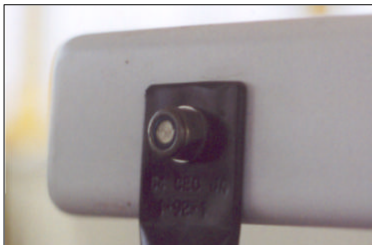
Marcaje Troquelado. I.E.S. "Mediterráneo". Málaga.
