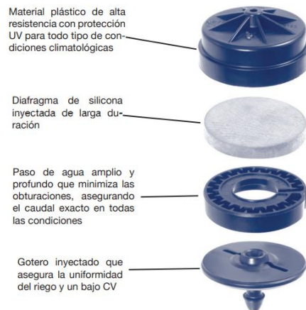
Ilustración 17. Composición del gotero
