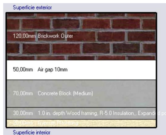
Figura 38. Sección muro Hipatia.
