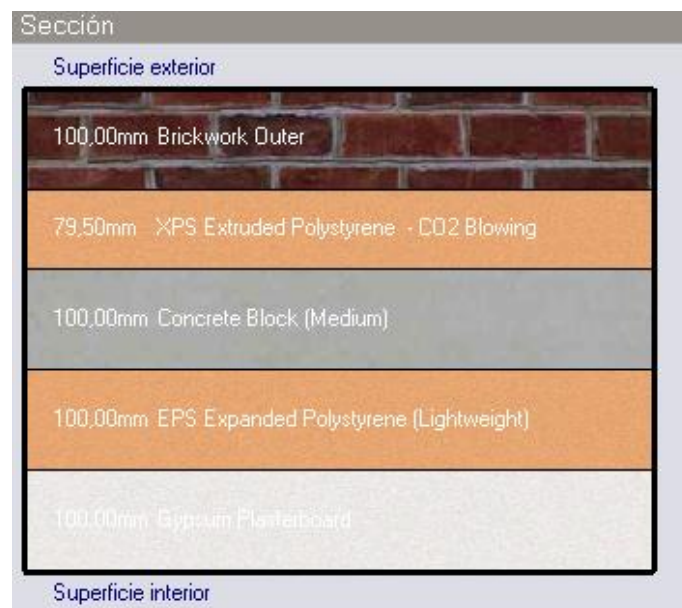
Figura 65. Nueva sección de muros en Lourdes.
