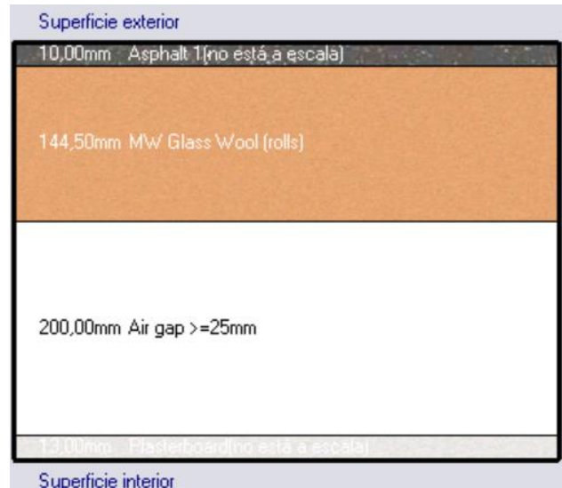
Figura 29. Sección cubierta Lourdes.
