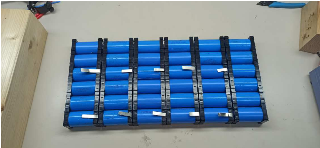
Figura 2.34: Conjunto de celdas unidas
