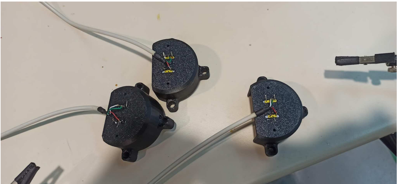
Figura 2.21: Codificadores en soporte de impresión 3D
