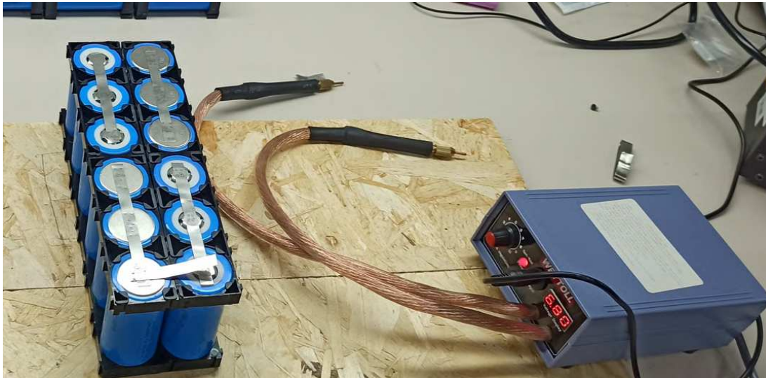
Figura 2.26: Imagen donde se ve el soldador por puntos usado y un paquete de 12 celdas
