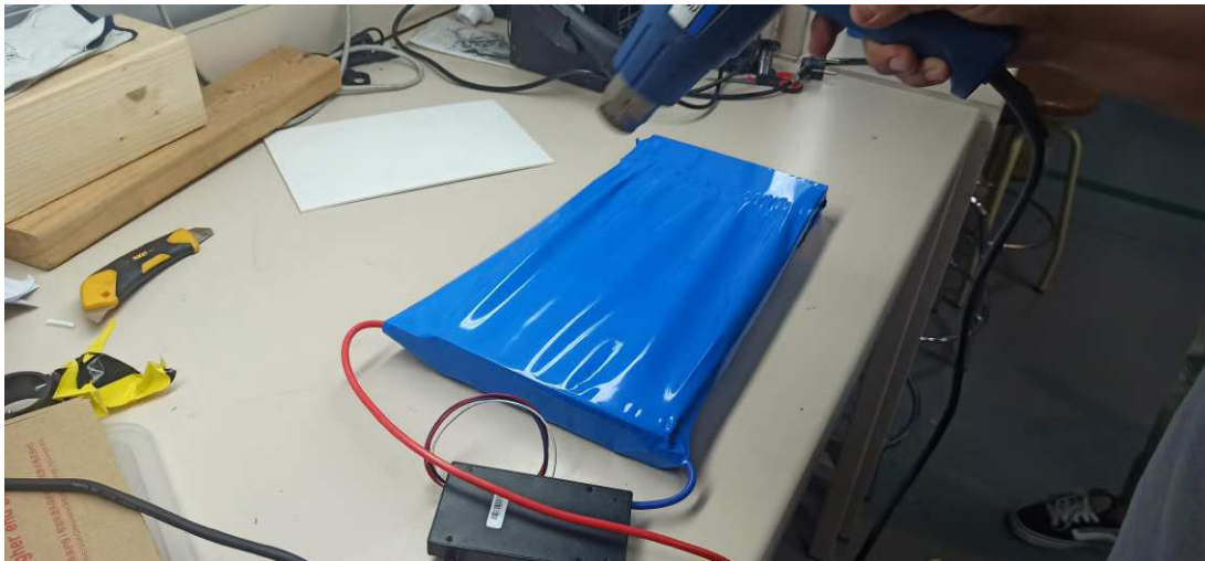
Figura 2.38: Proceso de sellado de la batería mediante termoretráctil
