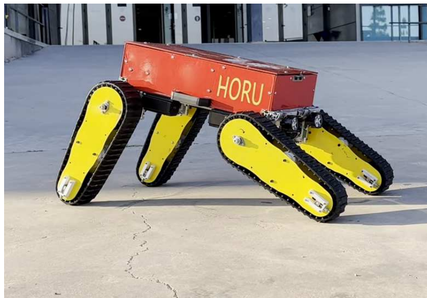
Figura 7.39: Horu en el modo de posición incremental
