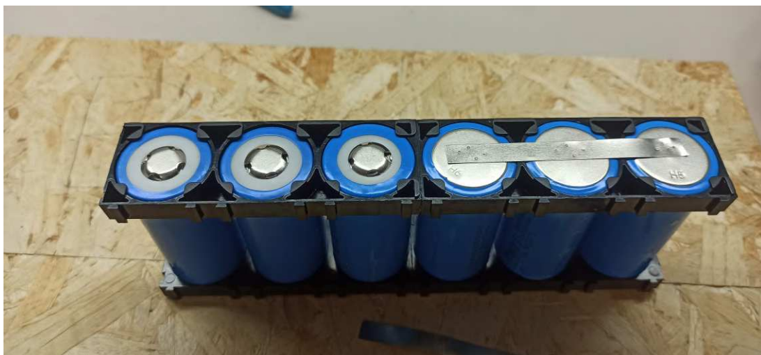
Figura 2.33: Unión de terna de celdas
