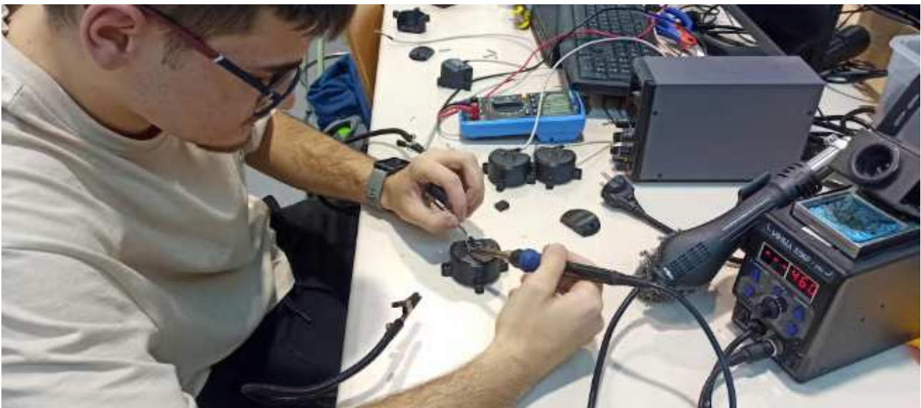
Figura 2.19: Proceso de soldadura de los encoders
