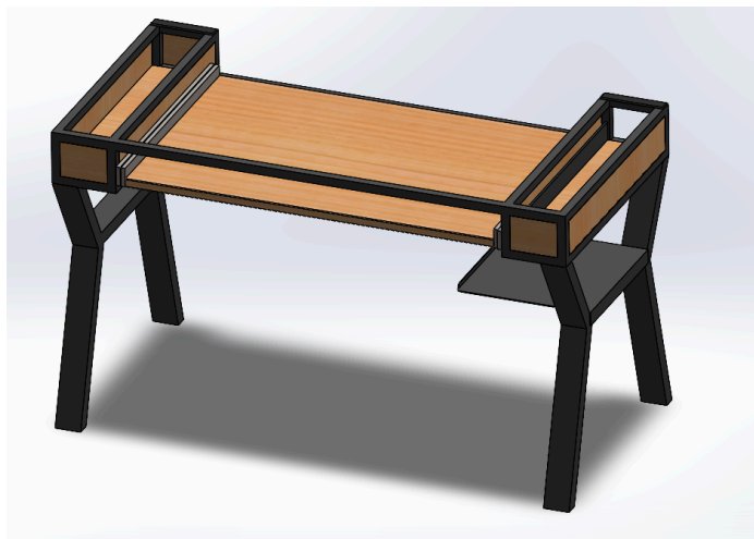
Figura 7.68. Montaje de las Patas con Balda, Guía Telescópica y Tablero Auxiliar (Fuente: Elaboración propia)
