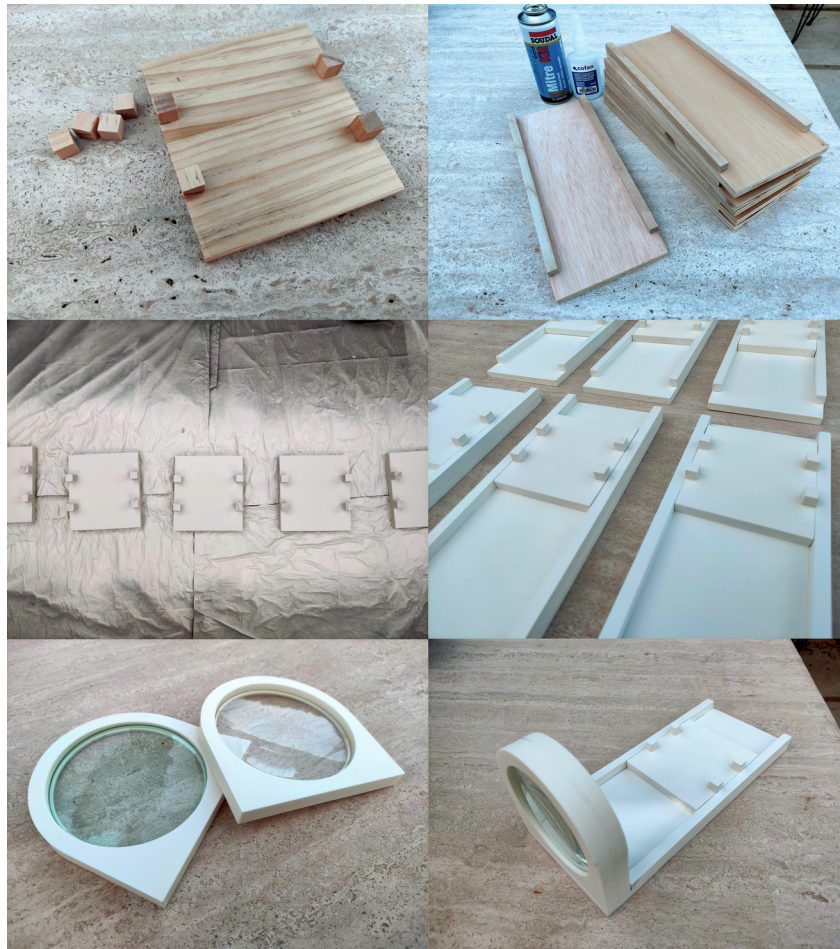
29. Proceso de la fabricación de las piezas proyector. Madera cruda, pintura blanca en spray, piezas impresas en plástico ABS y lentes convergentes.
