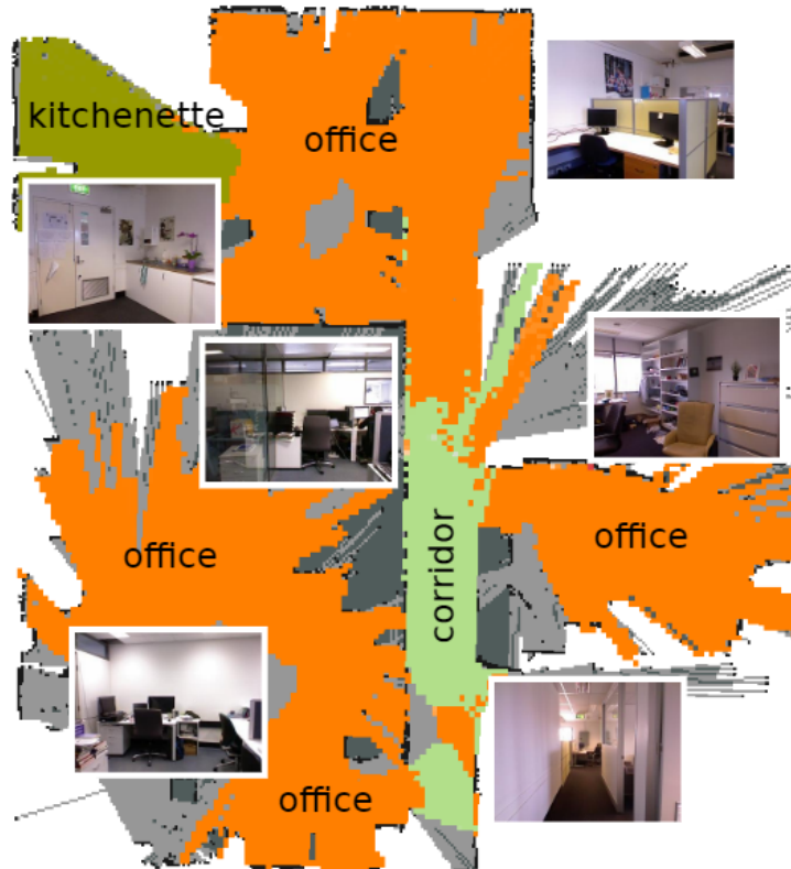
Figura 5: Ejemplo de categorización y segmentación de lugares en un mapa, siguiendo la propuesta de Sünderhauf et al. [55]. El método clasifica las imágenes de entrada utilizando una CNN desarrollada por Zhou et al. [65], y proyecta las etiquetas de escena resultantes sobre las celdas del mapa para asignar categorías semánticas a cada región.
