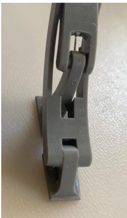
Imagen 45. Vista de exceso de resina en el prototipo. Elaboración propia.
