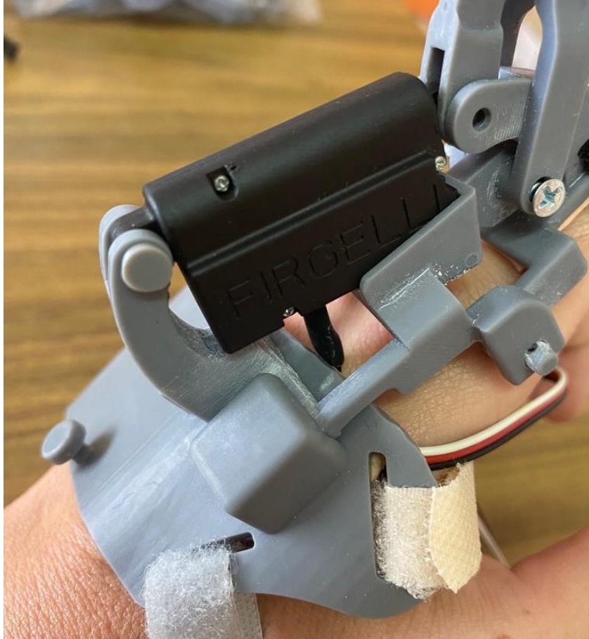
Imagen 49. Vista motor lineal encajado en el exoesqueleto. Elaboración propia.
