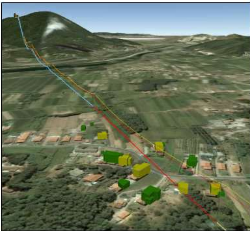
Figura 4. 11. LEAAT clasificadas en diferentes colores según la afectación del CM sobre la población y edificios circundantes. Fuente: Comelli et al., 2008
