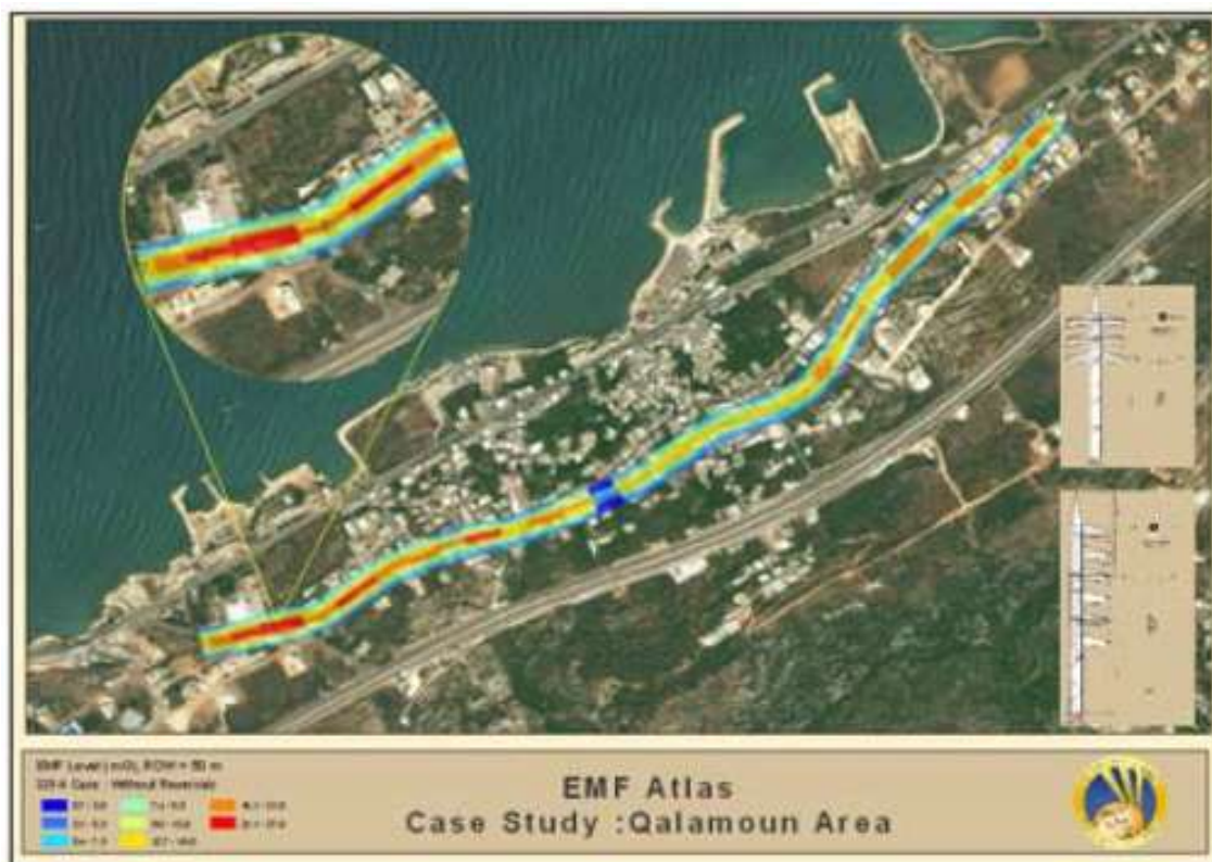
Figura 4. 5. Representación gráfica del CM mediante el SIG EMF Atlas. Fuente: Najjar et al., 2009
