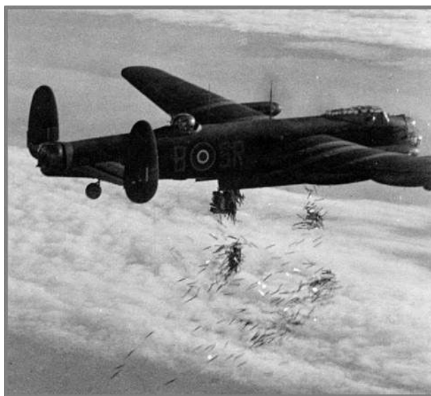
Figura 44. Reflectores antirradar desplegados desde un bombardero de la RAF Lancaster.
