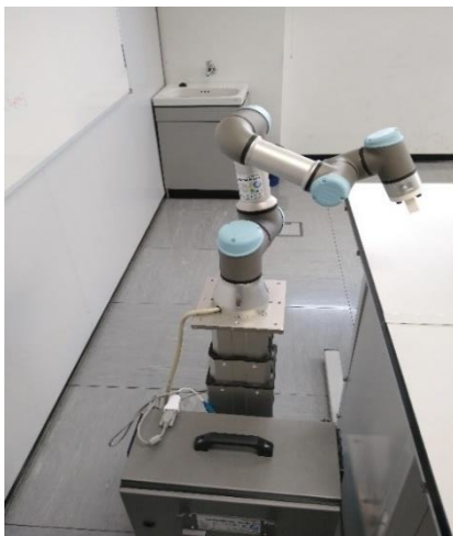
Figura 21. Brazo manipulador UR3 de Universal Robots (izquierda) y dispositivo háptico Phantom Omni de 3D Systems (derecha)
