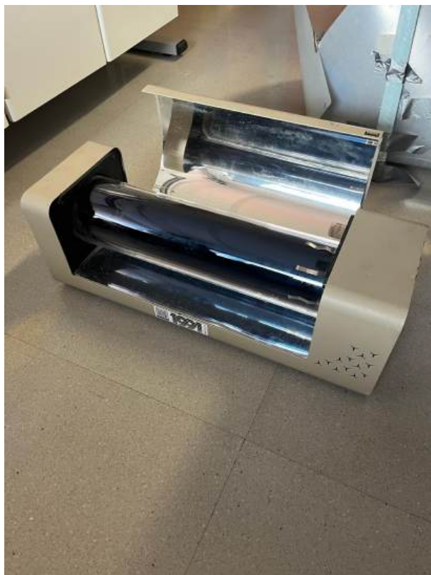
Figura 2.4: Cocina solar Tubo de Vacío abierta
