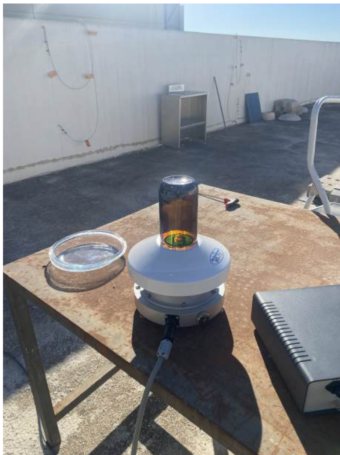
Figura 3.4: Medición del espectro que deja pasar el vidrio
