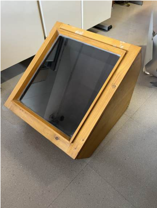
Figura 2.2: Cocina solar tipo caja sin reflectores
