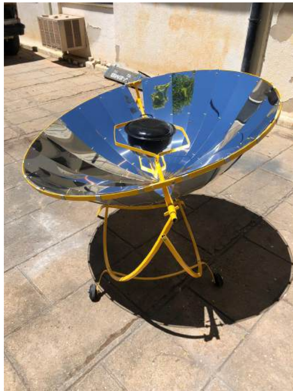
Figura 2.6: Cocina solar parabólica con foco cercano
