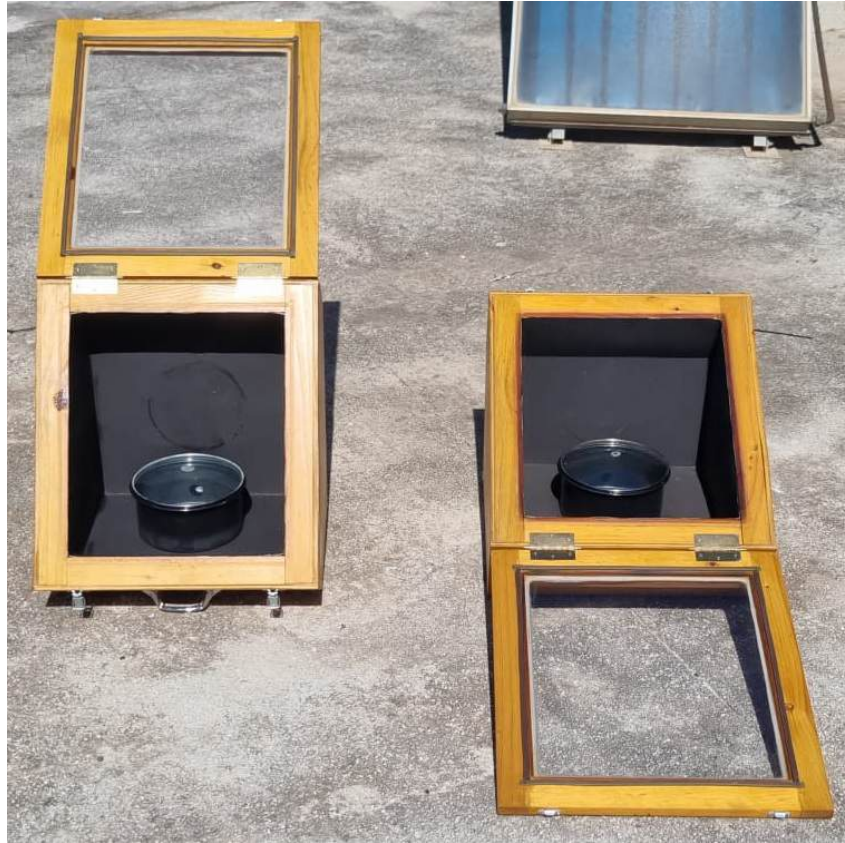
Figura 2.3: Cocina solar tipo caja abierta
