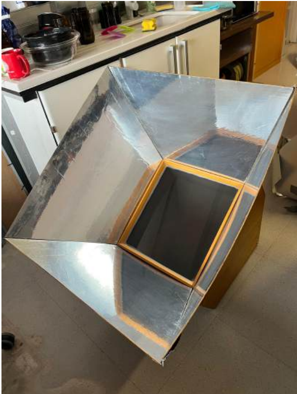
Figura 2.1: Cocina solar tipo caja con reflectores
