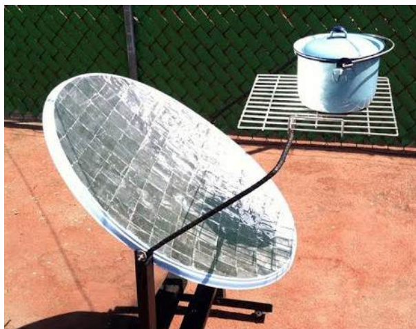
Figura 2.7: Cocina solar parabólica con foco alejado
