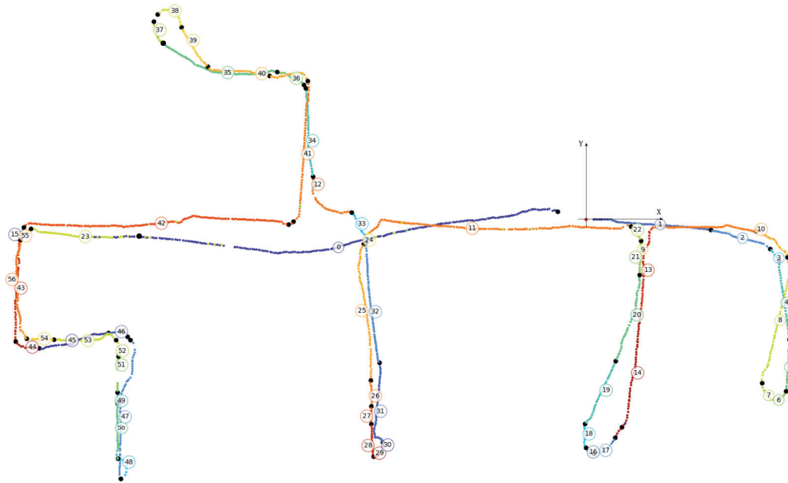
Figura 5.6: Mapa topológico resultado de aplicar la bipartición con \tau = 0,5 recursiva para el dataset Seq2_cloudy1 de COLA . Cada punto en el mapa representa un elemento del Mapa de Apariencia en su posición correspondiente. Los grupos identificados se representan por colores junto con el índice del grupo.
