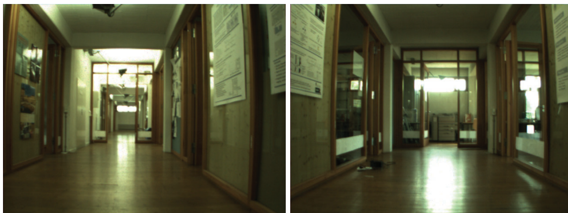
Figura 3.2: Ejemplo de Perceptual Aliasing (PA) representado por imágenes de dos pasillos diferentes. Se puede apreciar que la apariencia general es muy similar entre las imágenes, a pesar de tratarse de imágenes distantes en términos de pose.
