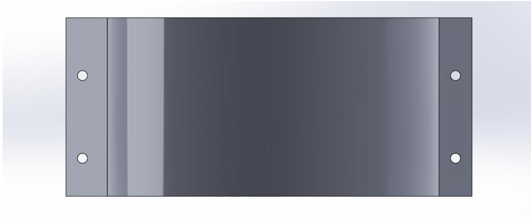
Imagen 21: Vista trasera del cilindro mostrando el chaflán y los taladros para anclaje.
