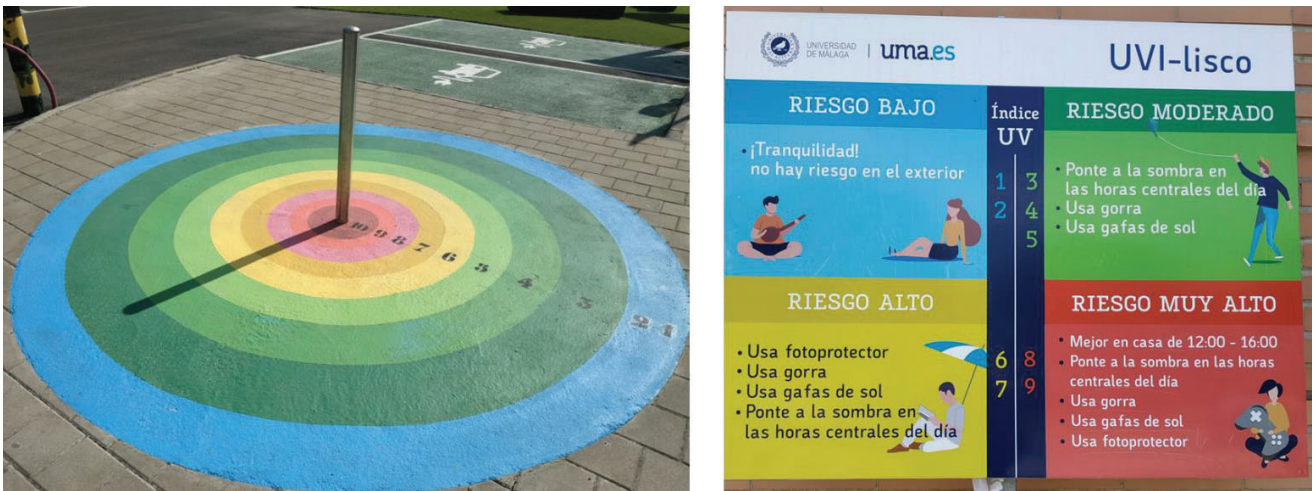
Figura 20. Figura de la diana de proyección de sombra basada en el modelo bidimensional. La distancia entre los diferentes puntos de la diana, que representan el índice UV guarda relación de dependencia de la altura del objeto de proyección de sombra. Al lado del UVILISCO se coloca un cartel informativo con medidas de protección asociadas a los niveles de riesgo correspondiente a cada franja de color.
