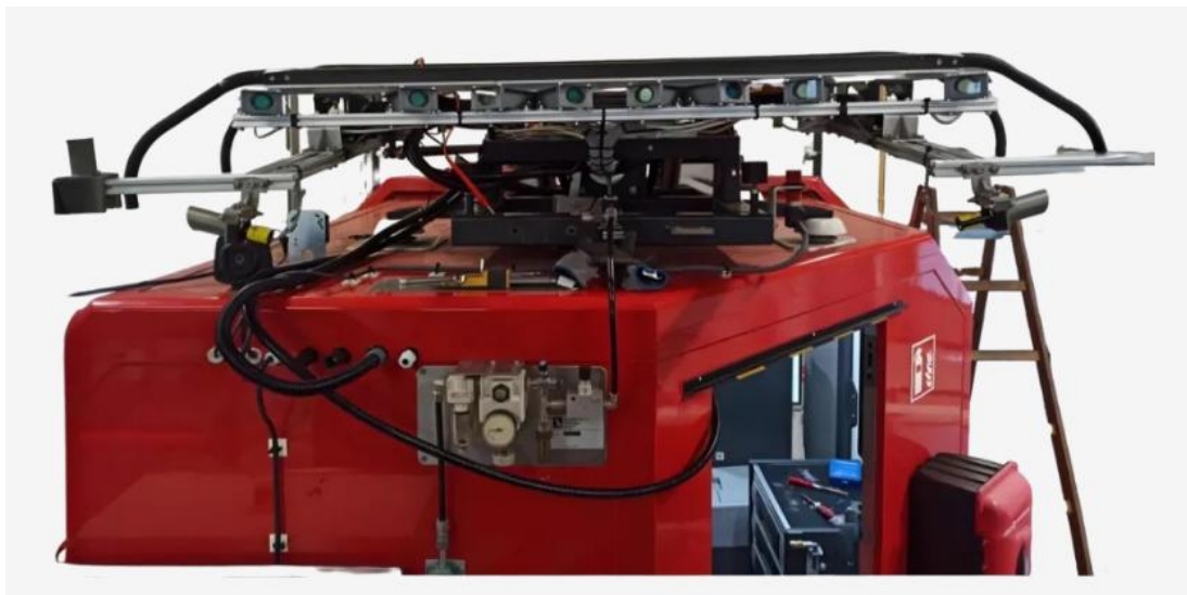
Figura 4. Dispositivo de medición en vehículo CatPro. [11]
