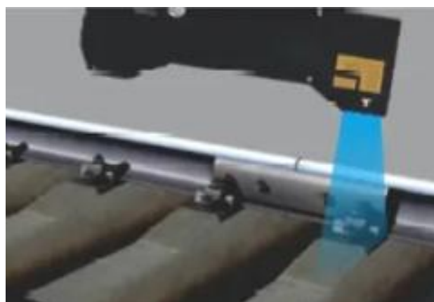
Figura 2. Dispositivo SinceVision 3D Laser Profile. [9]
