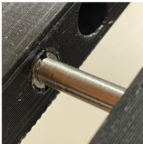
Figura 59. Ajuste sin holgura del juego guía + casquillo. [Material propio]
