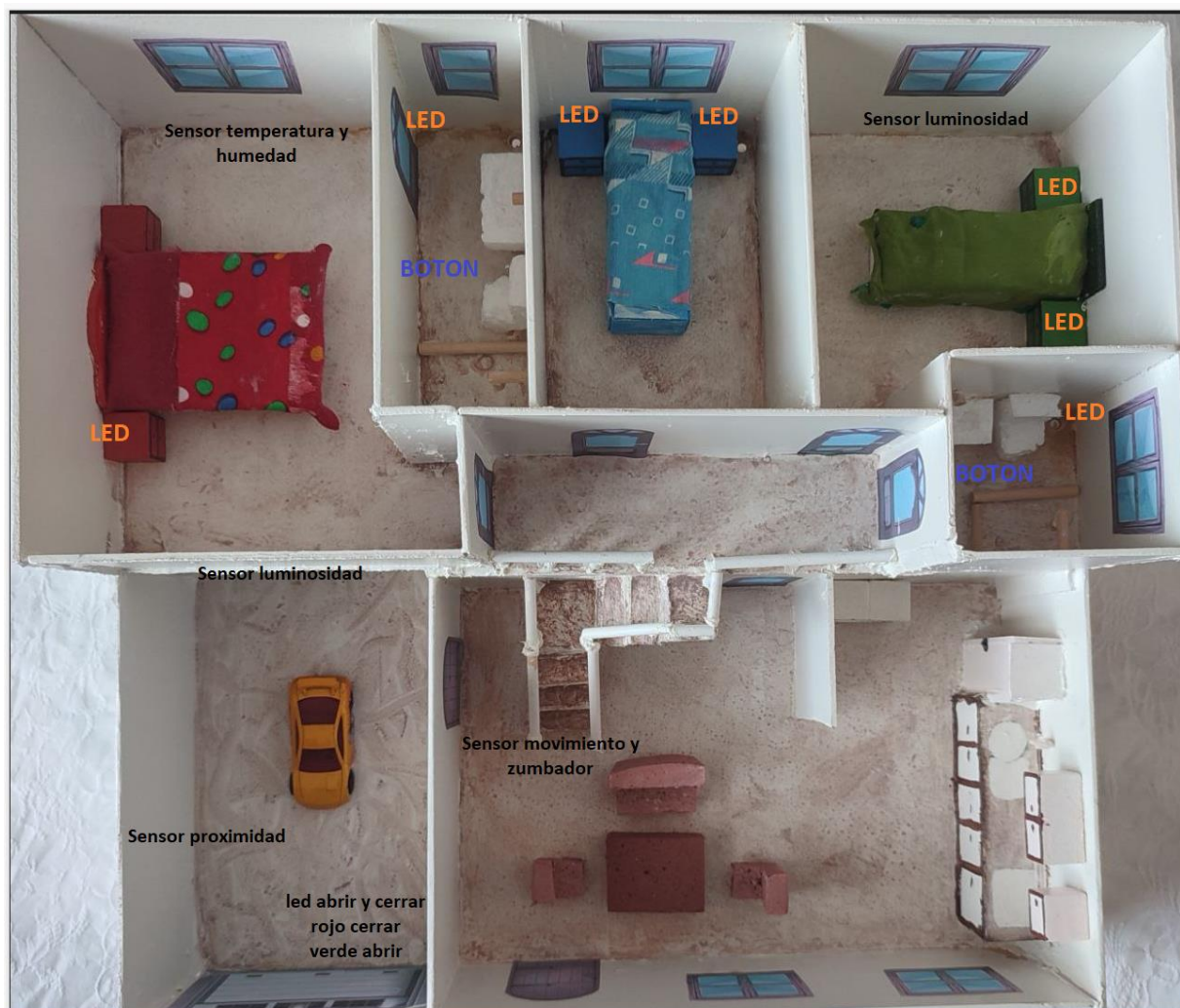
Figura 17: Foto de la casa con los sensores y placas situados (vista desde arriba)
