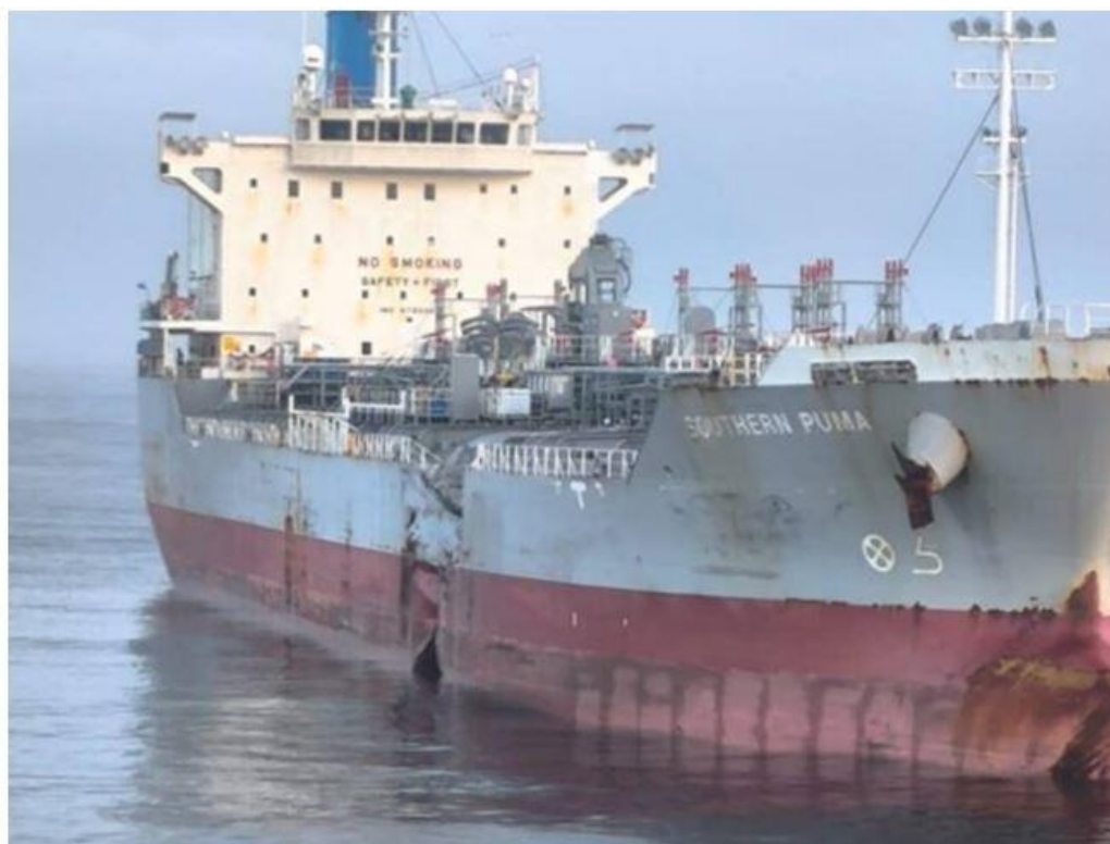
Daños en el Southern Puma al verter parafina en aguas del Estrecho tras su colisión con un barco granelero.
