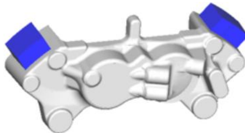
Figura 38: Elementos enfriadores en azul [3]
