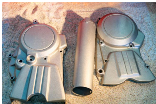
Figura 21: Piezas finales con huecos internos [26]
