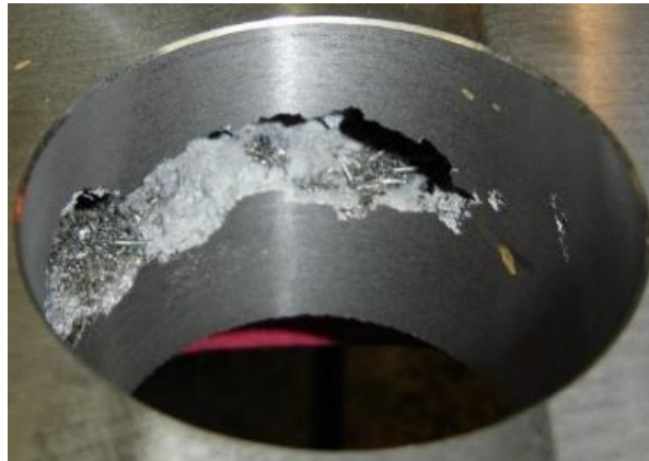
Figura 31: Ejemplo de rechupe [33]
