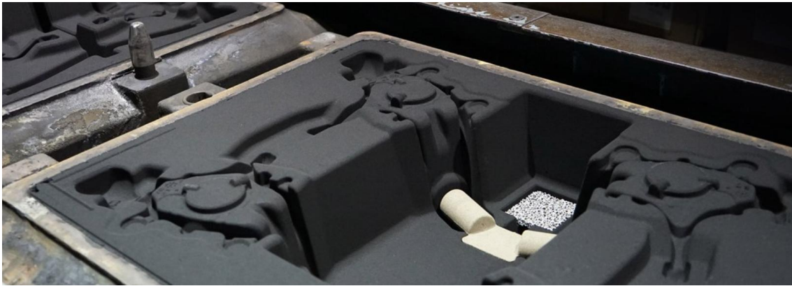
Figura 20: Molde con arena verde [24]
