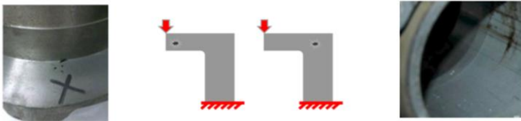
Figura 28: Ejemplos de defectos de porosidad o rechupes [3]
