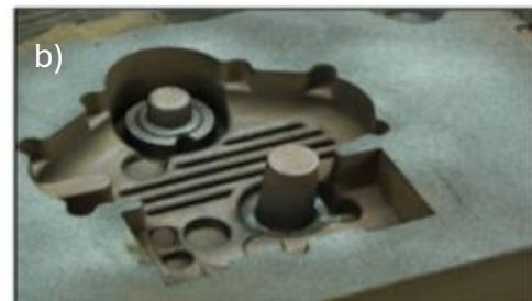
Figura 27: a) Línea de partición en molde metálico. b) Molde de arena [3]
