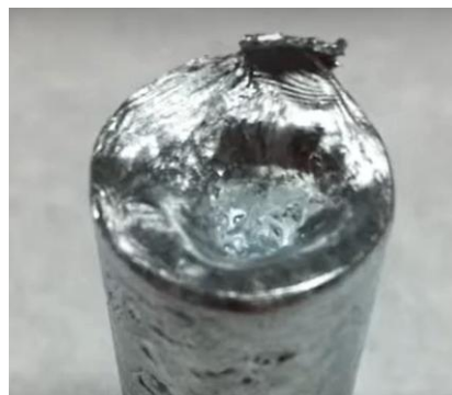
Figura 23: Ejemplo de rechupe en pieza fundida [29].
