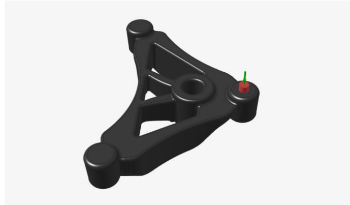
Figura 83: Pieza sin canal de llenado, mazarotas ni manguitos.
