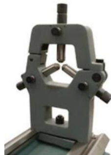
Figura 10. Contrapunto y luneta como sistemas de sujeción para piezas demasiado largas o delgadas. La imagen muestra una luneta fija [13].
