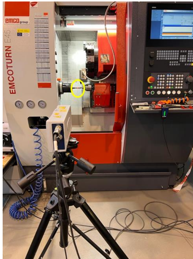
Figura 98. Incidencia del láser sobre la propia probeta a mecanizar.
