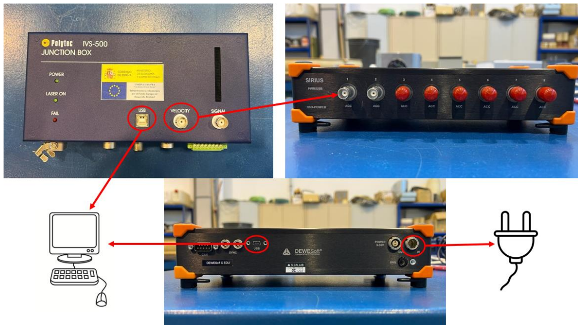
Figura 57. Conexiones PC – Amplificador - Caja de conexiones - corriente.
