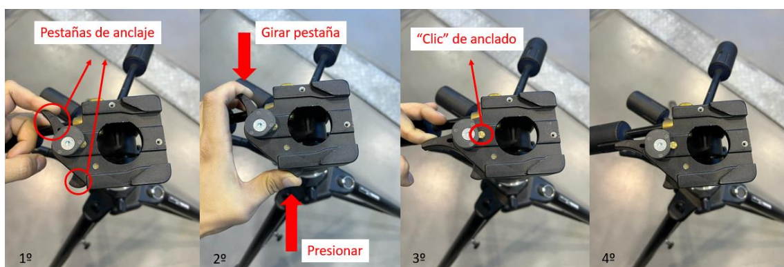
Figura 54. Preparación del soporte del trípode para la correcta fijación del vibrómetro.
