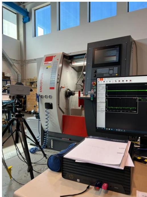
Figura 1. Obtención y análisis de vibraciones en un proceso de mecanizado con torno.
