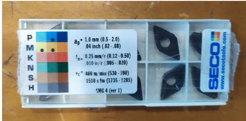
Figura 96. Ejemplo de caja de plaquitas con etiqueta de clasificación en buen estado.
