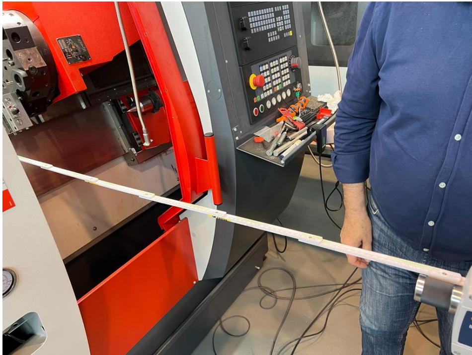
Figura 59. Distancia correcta de colocación de acuerdo con las marcas verdes.
