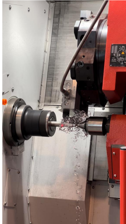
Figura 88. Interferencia de un nido de viruta en el láser.
