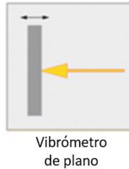
Figura 33. Esquema del haz de láser del vibrómetro de plano. Imagen adaptada de [26].
