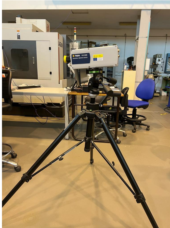
Figura 55. Vibrómetro fijado en el soporte del trípode.
