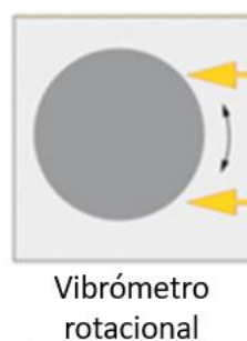
Figura 32. Esquema de los haces de láser del vibrómetro rotacional. Imagen adaptada de [26].
