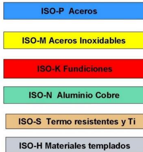
Figura 97. Los seis grupos de la Clasificación ISO de metales duros [43].
