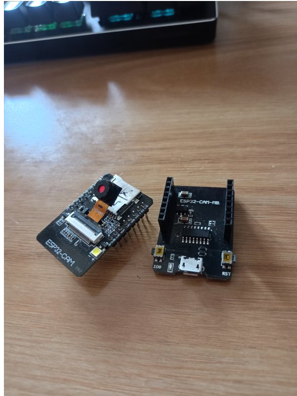
Figura 1.5: Imagen del módulo ESP32Cam y su correspondiente placa programadora
