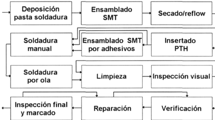
Figura 21.17: Diagrama de flujo de un proceso de soldadura en tecnología mixta.
