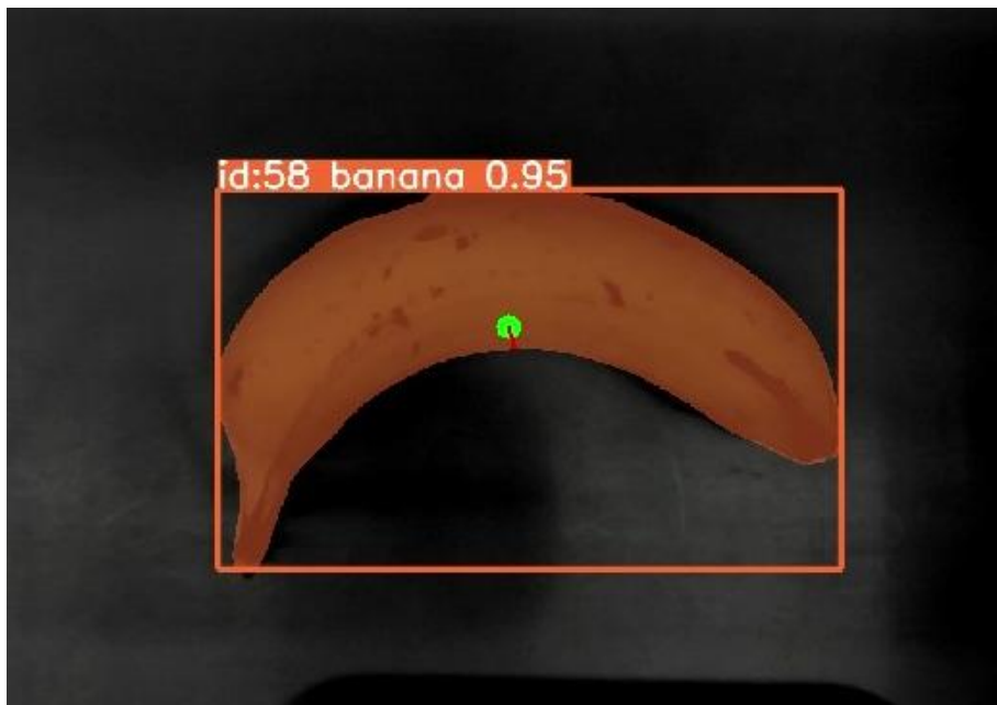
Figura 3.8. Representación del resultado del cálculo del punto y normal de la superficie de agarre en el proceso de manipulación. Punto de agarre en verde y normal a superficie en rojo (representación bidimensional)
