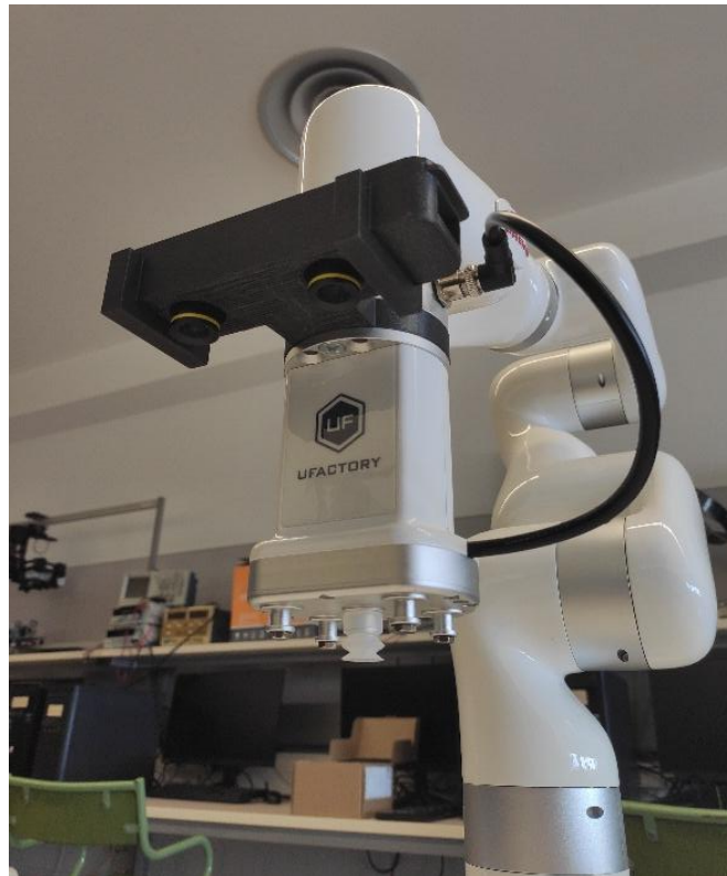
Figura 2.10. Efecto final del manipulador con soporte para la cámara y ventosa
