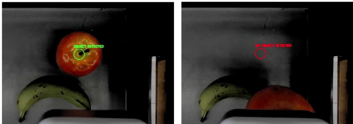
a) Objeto detectado: Agarre fallido b) Objeto no detectado: Agarre exitoso Figura 3.10. Mecanismo de detección de objeto seleccionado para verificación de agarre
