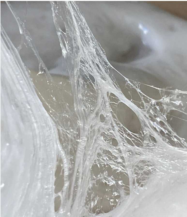
Fig 32. Arriba izquierda. Imagen propia. Styrum . (2024). Proceso de disolución y termoformado del poliestireno expandido.
