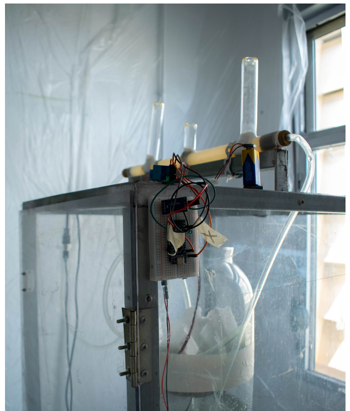
Fig 20. Abajo derecha. Imagen propia. Humusidades . (2024). Parte superior con vista de microchip 328P CH340.
