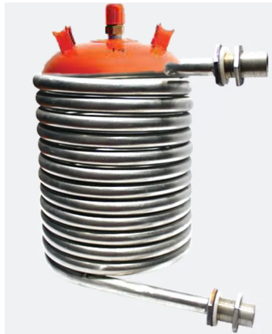
Figura 9. Prototipo sistema de tuberías para gasificación de bombona de butano.
