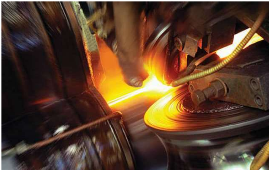
Ilustración 19. Soldadura por inducción y alta frecuencia.
