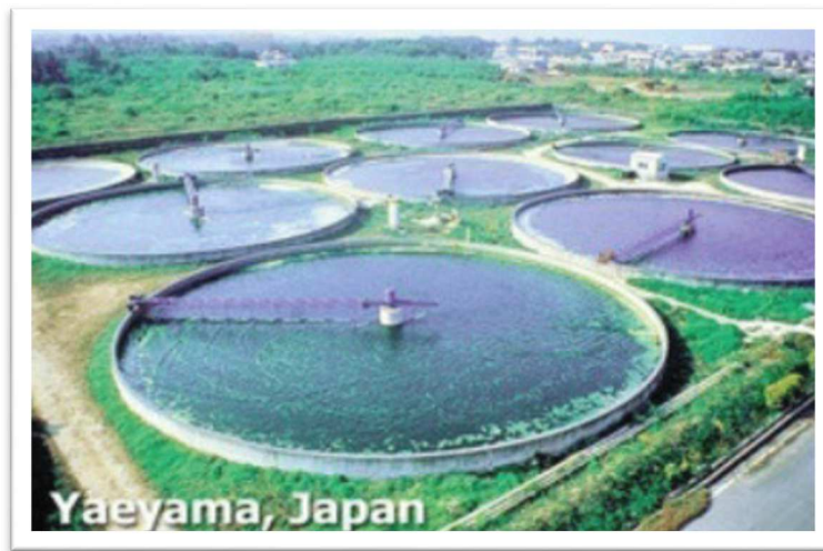
Imagen 5: Sistema de cultivo en estanques circulares de Chlorella sp. en Yaeyama en la isla de Okinawa, sur de Japón. (Fuente: Imen Hamed, 2016).
