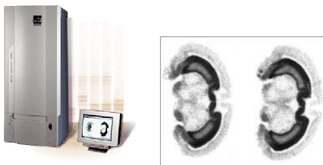
Figura 2.10. Elementos principales e imágenes obtenidas por el adquisidor \beta -IMAGER™ 2000. El adquisidor, a la izquierda, posee una cámara de intensificación, donde se vierte el TEA, un detector de centelleo y una bandeja donde se carga la muestra. Al lado, se observa el ordenador de adquisición, que permite el control y la visualización a tiempo real de la adquisición, 500 veces más rápida que la exposición fotográfica. Las imágenes de la derecha son un ejemplo de la visualización directa en la pantalla del adquisidor.
