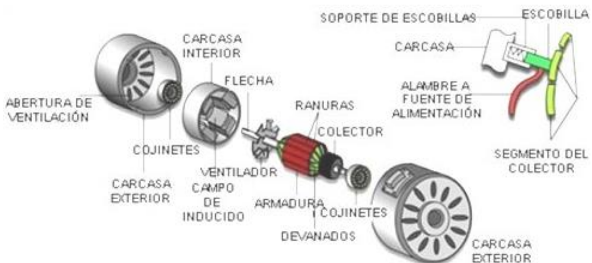
Figura 9: Despiece de in motor de corriente continua Fuente:[33]
