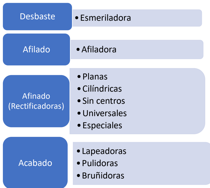
Figura 2: Clasificación de las máquinas herramientas de corte por abrasivos [4]
