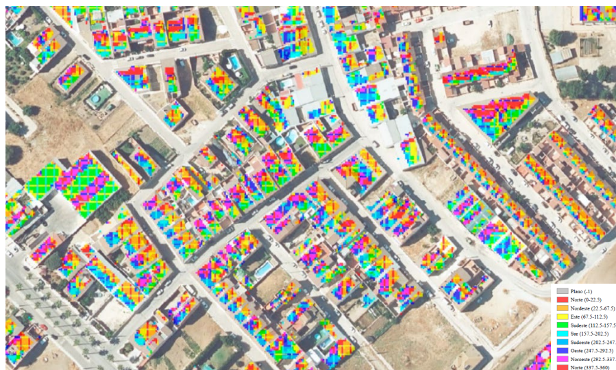
Figura 30. Orientación de cubiertas.
