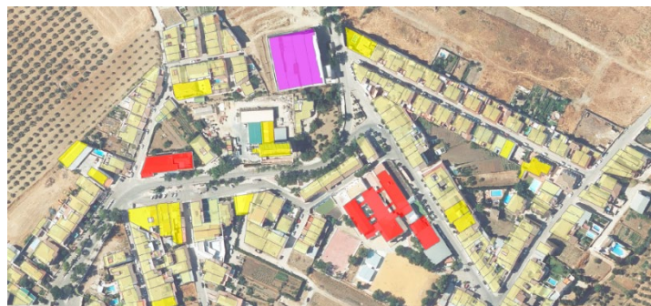
Figura 57. Potencia instalada para módulos Si Amorfo por parcela.
