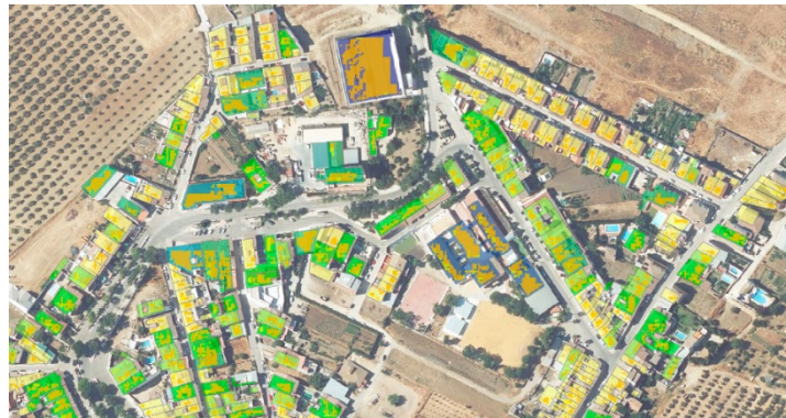
Figura 62. Energía producida para módulos CIS por parcela.
