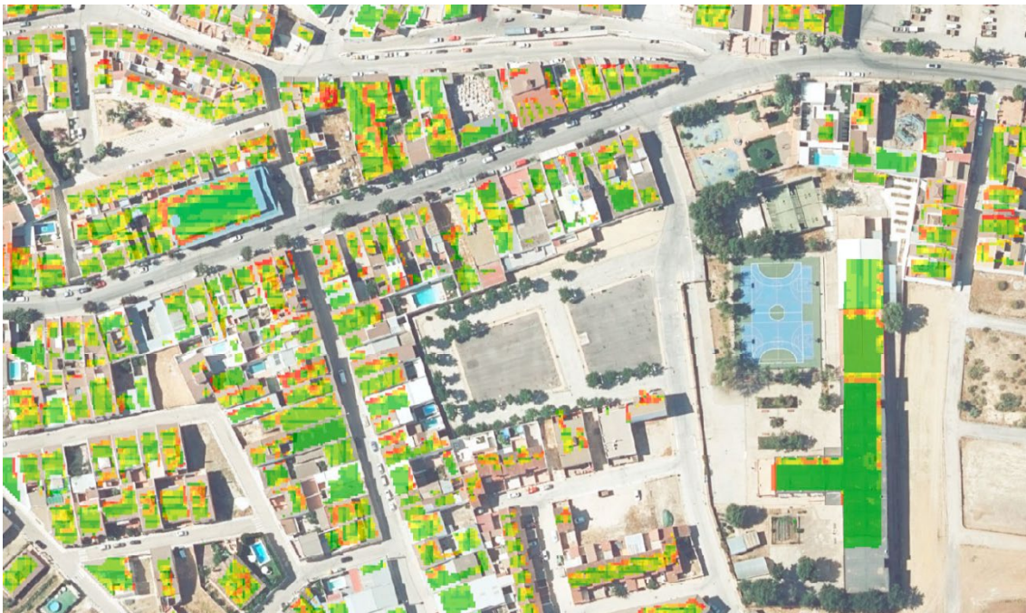
Figura 28. Capa de pendiente de las cubiertas ‘Pend_Cubiert’.
