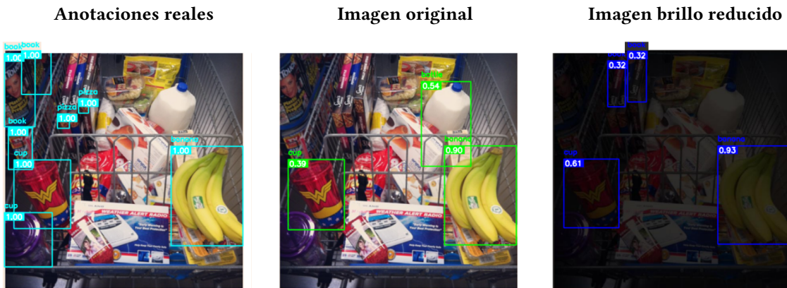
Figura 52: Comparación de distintas detecciones para una misma imagen. De nuevo, la imagen oscurecida genera falsos positivos y omite objetos como la botella.
