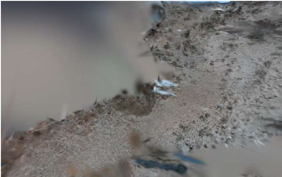
Figura 18: Vista general del modelo generado de la trayectoria 1. Se puede ver cómo las inexactitudes en la reconstrucción dispersa del extremo final de la trayectoria afectan negativamente al resultado en dicha zona
