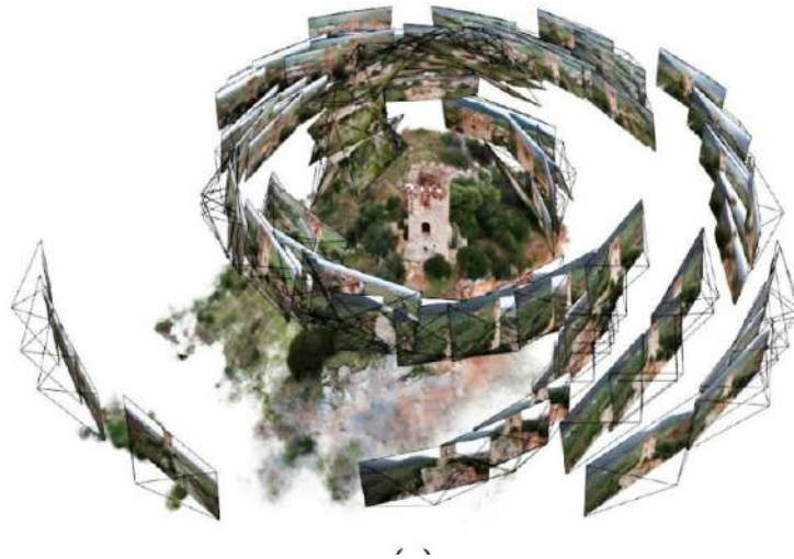
Figura 9: Reconstrucción tridimensional mediante técnicas de fotogrametría basadas en NeRF de la Torre di Caprona en Pisa, Italia. Imagen adaptada de [9].
