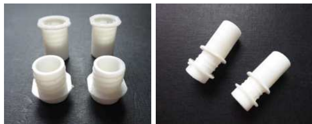
Figura H.10: Pruebas mecanismo rosca del envase 2
