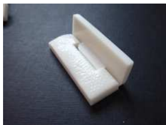
Figura H.4: Prueba bisagra funcional del envase 1
