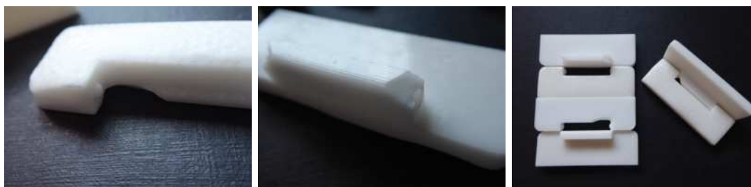
Figura H.5: Fallos superficiales en pruebas de bisagra
