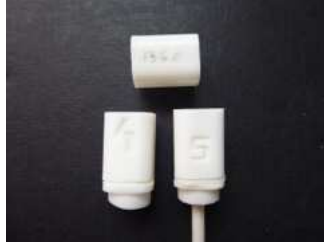
Figura H.12: Tolerancias encaje pieza 1 del envase 2
