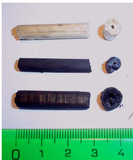
Figura 3.17. Fotografía digital de (a) cáñamo, (b) monolito de carbón CÑ-800 y (c) monolito de carbón activo CÑ2-400.
