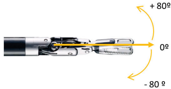
Figura 3.5: Movimiento del grado de libertad pitch
