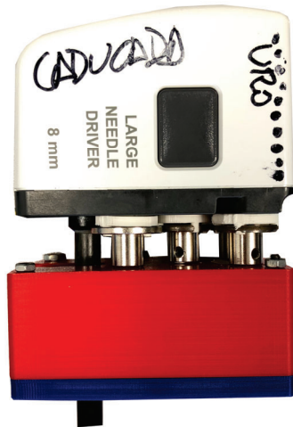
(a) Unión de los motores con la herramienta
