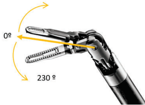
Figura 3.11: Movimiento del grado de libertad jaw
