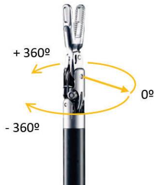
Figura 3.2: Movimiento del grado de libertad roll
