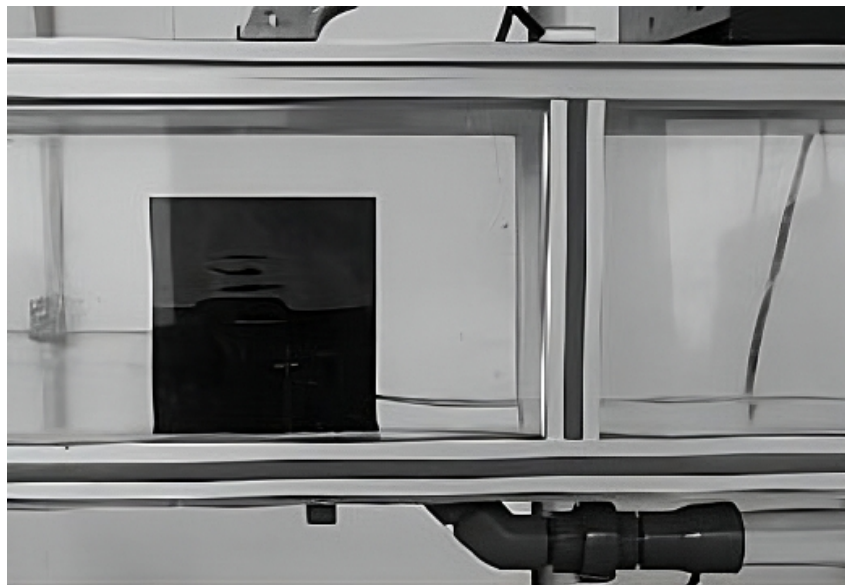
Figura 5.28: Imagen promedio experimento Cutthroat Flume para un caudal de 2000 (l/h).
