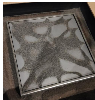
Figura 11. Experimento de arena situada en placa que vibra
