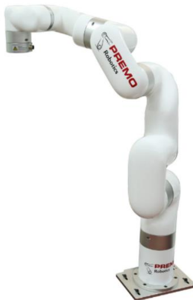
Figura 12. Brazo robótico colaborativo de seis grados de libertad pArm6 [19].
