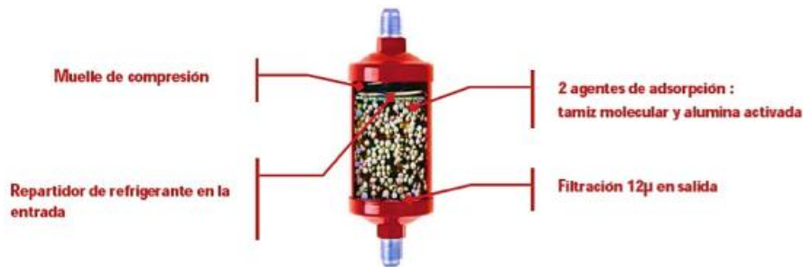
Figura 25. Filtro deshidratador.
