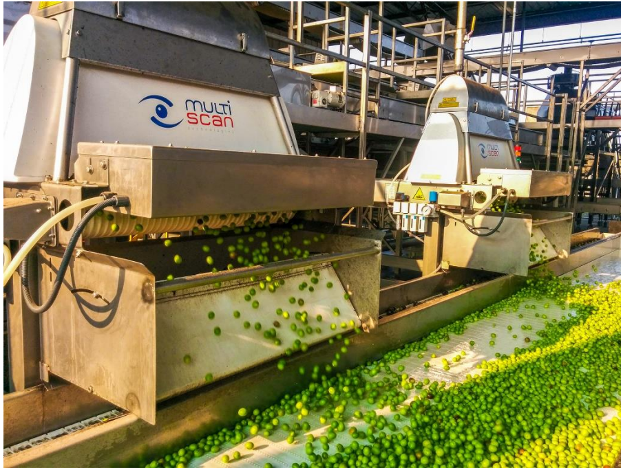
Figura 26: Máquina clasificadora de aceitunas por visión artificial (MultiScan Technologies)
