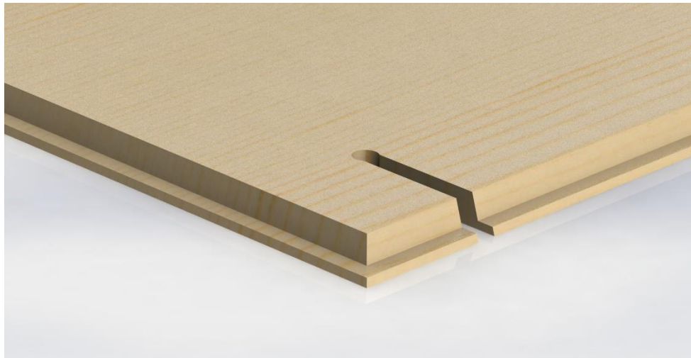
Figura 25. Detalle de la guía para insertar el cable en la base de madera. Fuente: elaboración propia
